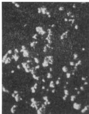
Abbild. 4. Beim Kurzschluß zwischen den Siliciumteilchen abgeschleuderte Siliciumkugeln. Vergr. 108fach
